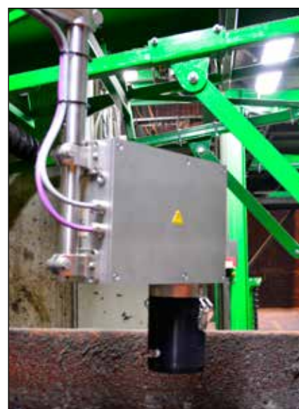
De vochtmeter van Inventech meet continu en levert belangrijke data voor het nauwkeurig aansturen van het proces
