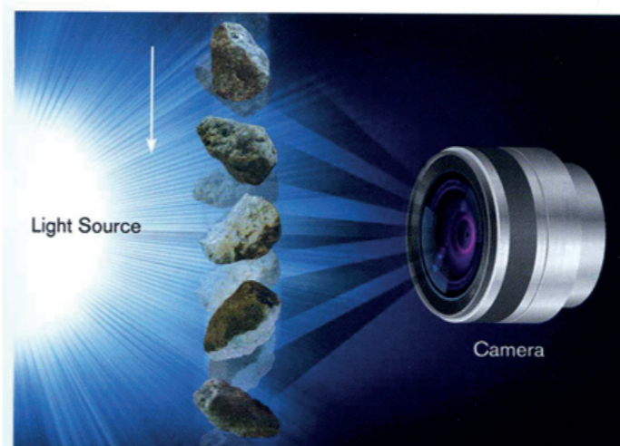
Afb. 4 Bij particle-tracking wordt van elk afzonderlijk deeltje een reeks afbeeldingen gemaakt waardoor alle afmetingen van het deeltje nauwkeurig kunnen worden bepaald
